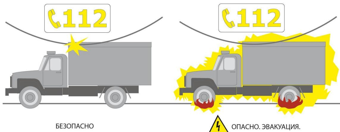
4. В случае возгорания шин необходимо покинуть кабину автомобиля:
